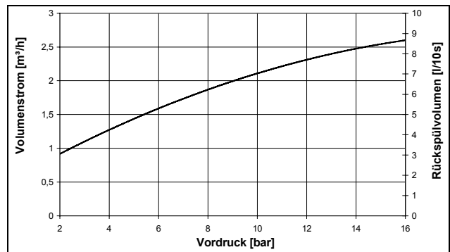
Abb. 6: Rückspülwassermenge bei ca. 10 Sek. Rückspüldauer
